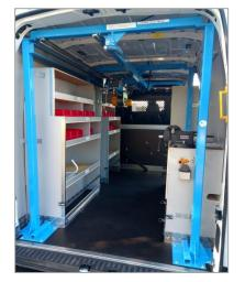
Caractéristiques Techniques Tension 12 V (Alimentée sur la batterie du véhicule) 80 A Ampérage Capacité de charge 500 Kg Poids 340 Kg Sortie à l'arrière 1 m Normes Directive 2006-42-CE, 2006-95-CE, 2006-98-CEEN 62311-2008, EN 12895-2000, EN 61000-6-2-2005
